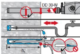
Mit Reinigung des Bohrlochs zur Montage in alle Richtungen.
