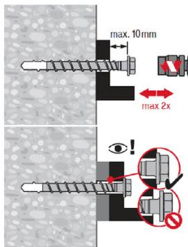
Der Dübel darf maximal zweimal adjustiert werden. Die bei der Adjustierung erfolgte Unterfütterung darf insgesamt maximal 10 mm betragen. Die erforderliche Setztiefe  $h_{nom2}$  oder  $h_{nom3}$  muss nach der Adjustierung eingehalten werden.
