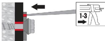
Ringspalt zwischen Stahlelement und Anbauteil mit einem Hilti Injektionsmörtel HIT-HY --- oder HIT-RE ... mit 1 bis 3 Hüben verfüllen. Befolgen Sie die Bedienungsanleitung, die dem entsprechenden Hilti Injektionsmörtel beigelegt ist. Nach Ablauf der erforderlichen Aushärtezeit  $t_{cure}$  kann die Befestigung belastet werden.
