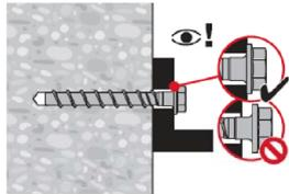
**Setzen des Dübels mit Adjustierung** für Kohlenstoffstahl Schraubenarten.
