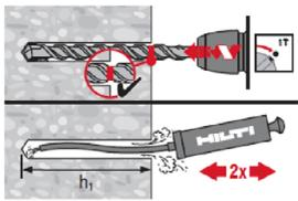
Mit Reinigung des Bohrlochs zur Montage in Wand oder Bodenposition.
