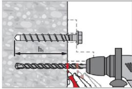
Erforderliche Bohrtiefe  $h_1$  für Durchsteckmontage oder Vorsteckmontage auf dem Bohrer oder der Bohrkronen markieren.
