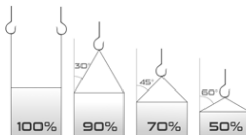
Fig. 7: reduksjon av bæreevnen til skru med hensyn til hengevinkelen
