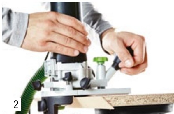
2 Fräs sedan arbetsobjektet plant.
