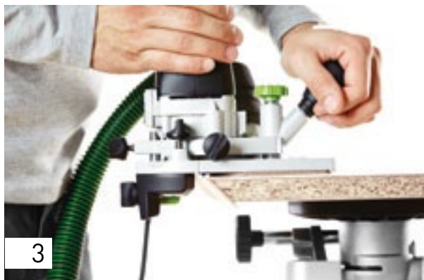
3 Kontrollera noga att utsugskåpan ligger an undertill direkt mot arbetsobjektet och på så sätt kan användas som styrning. Därefter formar du till radien på träkanten med ett slippapper.
