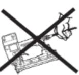
**5.2) VERKTØYET MÅ ALDRI FLYTTES VED Å DRA I LUFTSLANGEN** Hvis man drar verktøyet etter luftslangen kan dette svekke verktøyhuset og føre til tidlige defekter på dette, eventuelt kan det oppstå skader på slangen, pakninger og andre tilsvarende komponenter. Verktøyhus som er slitt og svekket kan spreke ved bruk og føre til alvorlige skader for brukeren eller andre personer.
