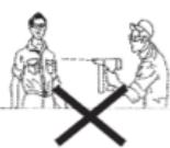
**5.4) PASS PÅ AT VERKTØYET ALLTID PEKER I EN SIKKER RETNING** vekk fra andre. Man må alltid gå ut fra at verktøyet er ladet, med fullt trykk. Man må til enhver tid forsikre seg om at ingen er i den potensielle skuddlinjen for et utløst feste hvis dette skulle gå rett gjennom underlaget og fly fritt videre. Et feste på avveie kan føre til alvorlige skader (blindhet) for personer i nærheten.
