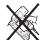
**5.1) MAN MÅ ALDRI HOLDE, TRANSPORTERE ELLER PÅ ANDRE MÅTER BÆRE VERKTØYET MED AVTREKKEREN AKTIVERT.** Verktøyet må kobles fra lufttilførselen hvis det må flyttes til en annen arbeidsposisjon. En tilfeldig eller uoverveid kontakt med sikringen mens avtrekkeren er aktivert, kan føre til at et uventet eller uønsket feste skytes ut, noe som kan resultere i alvorlige skader for brukeren eller andre personer.
