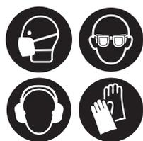
i. **Należy stosować odpowiednie osobiste wyposażenie ochronne:** ochronę słuchu, okulary ochronne, maskę przeciwpyłową przy pracach związanych z pyleniem, rękawice ochronne przy pracach z materiałami szorstkimi oraz przy wymianie narzędzia.
