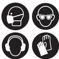
i. **Indossare un equipaggiamento di protezione adatto:** protezioni acustiche, occhiali protettivi, mascherina antipolvere in caso di lavorazioni che ne causano la formazione, guanti protettivi per materiali grezzi e per la sostituzione degli utensili.
