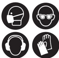
i. **Používejte vhodné osobní ochranné pomůcky:** chrániče sluchu, ochranné brýle, respirátor při prašných pracích, pracovní rukavice při obrábění drsných materiálů a při výměně nástroje.
