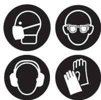
i. **Пользуйтесь подходящими средствами индивидуальной защиты:** защитные наушники, защитные очки, респиратор (при обработке пылеобразующих материалов), защитные перчатки (при обработке грубых материалов и смене рабочего инструмента).
